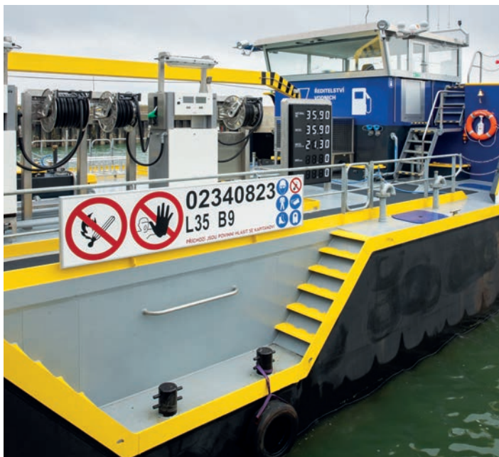
Detail platformy pro přístup na malá plavidla
