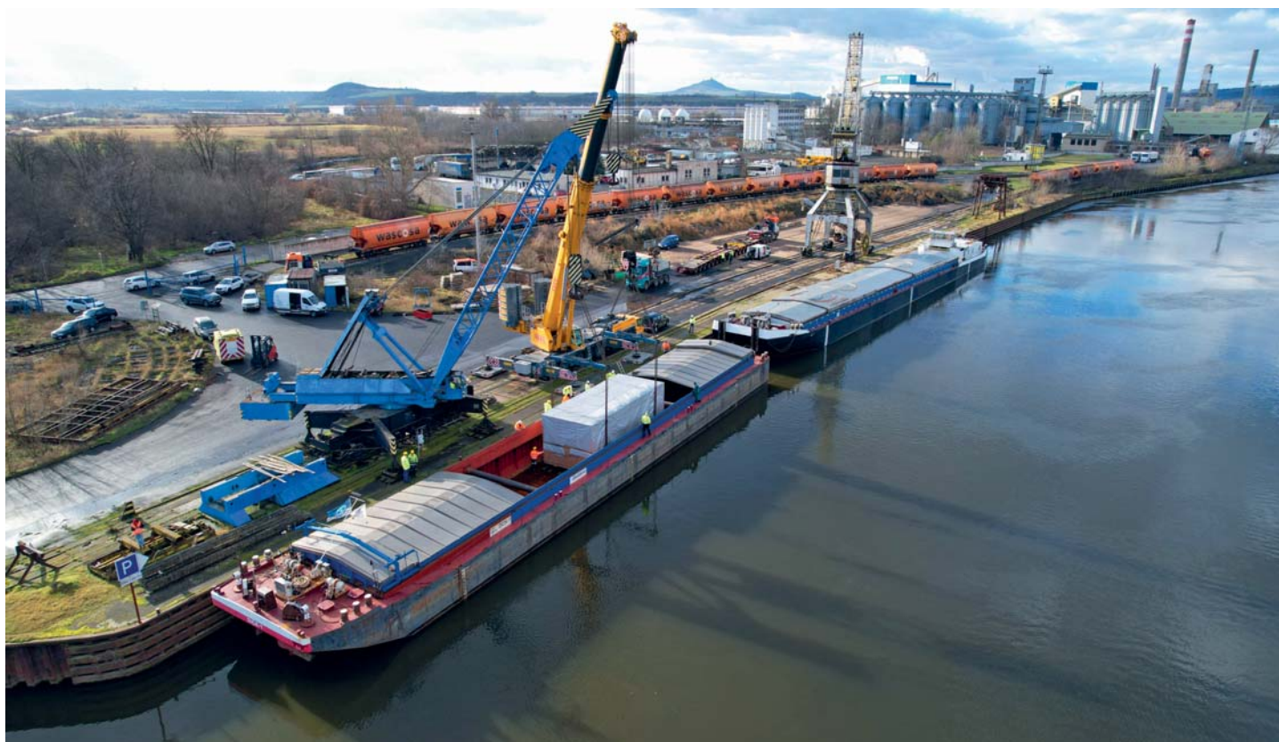
Nakládka 221tunového generátoru v přístavu Lovosice 31. ledna 2025
